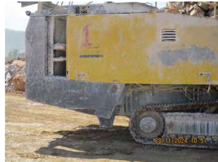
ภาพที่ 2-12 เครื่องเจาะรูระเบิดที่ติดตั้งเครื่องดักจับฝุ่นแบบถ่วงกรอง (Dust Collector)
