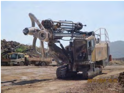
ภาพที่ 2-12 เครื่องเจาะรูระเบิดที่ติดตั้งเครื่องดักจับฝุ่นแบบถ่วงกรอง (Dust Collector)
